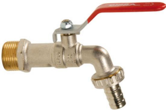
Robinet de puisage à sphère M 20/27. Il est fabriqué en laiton pour plus de robustesse et de longévité. Il dispose d'une poignée plate et est livré avec un nez de robinet F 20/27 pour un tuyau de diamètre 15 mm.
